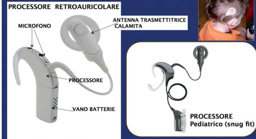
basale e medio della chiocciola. Funzionamento del dispositivo: i segnali sonori sono elaborati dalla parte esterna dell'IC e vengono inviati alla parte interna attraverso onde radio che attraversano la cute.
