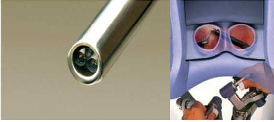
Fig. 2 Ottica del dVSS, sulla sinistra. Visore binoculare e impugnature, sulla destra
